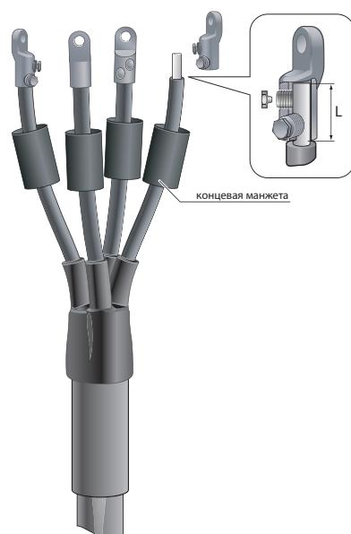
**6.1** Снять с концов каждой жилы изоляцию на длине, равной глубине хвостовика наконечника, и очистить растворителем поверхности оголенных участков жил;
